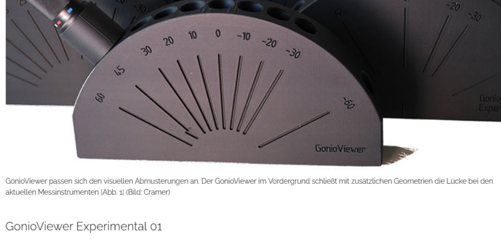
GonioViewer passen sich den visuellen Abmusterungen an. Der GonioViewer im Vordergrund schließt mit zusätzlichen Geometrien die Lücke bei den aktuellen Messinstrumenten (Abb. 1) (Bild: Cramer)
