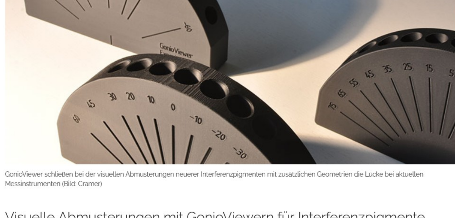
GonioViewer schließen bei der visuellen Abmusterungen neuerer Interferenzpigmenten mit zusätzlichen Geometrien die Lücke bei aktuellen Messinstrumenten (Bild: Cramer)
