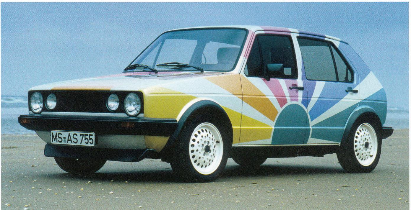
**Eine Mehrfarbenlackierung mit Perleffekt-Mischlacken. Die waagerechten Flächen wurden 8x mit Klarlack lackiert. Zwischen den Lackierungen wurden die Flächen geschliffen, so dass zum Schluss keine Übergänge zu fühlen waren.**
