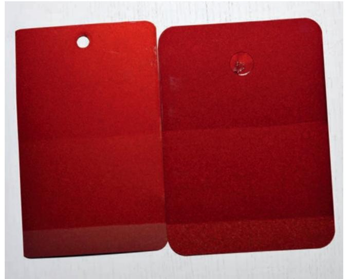
Einfache Metallic-Lackierung am unteren Rand, zusätzlich Farbschicht in der Mitte und mit Klarlack im oberen Bereich.
