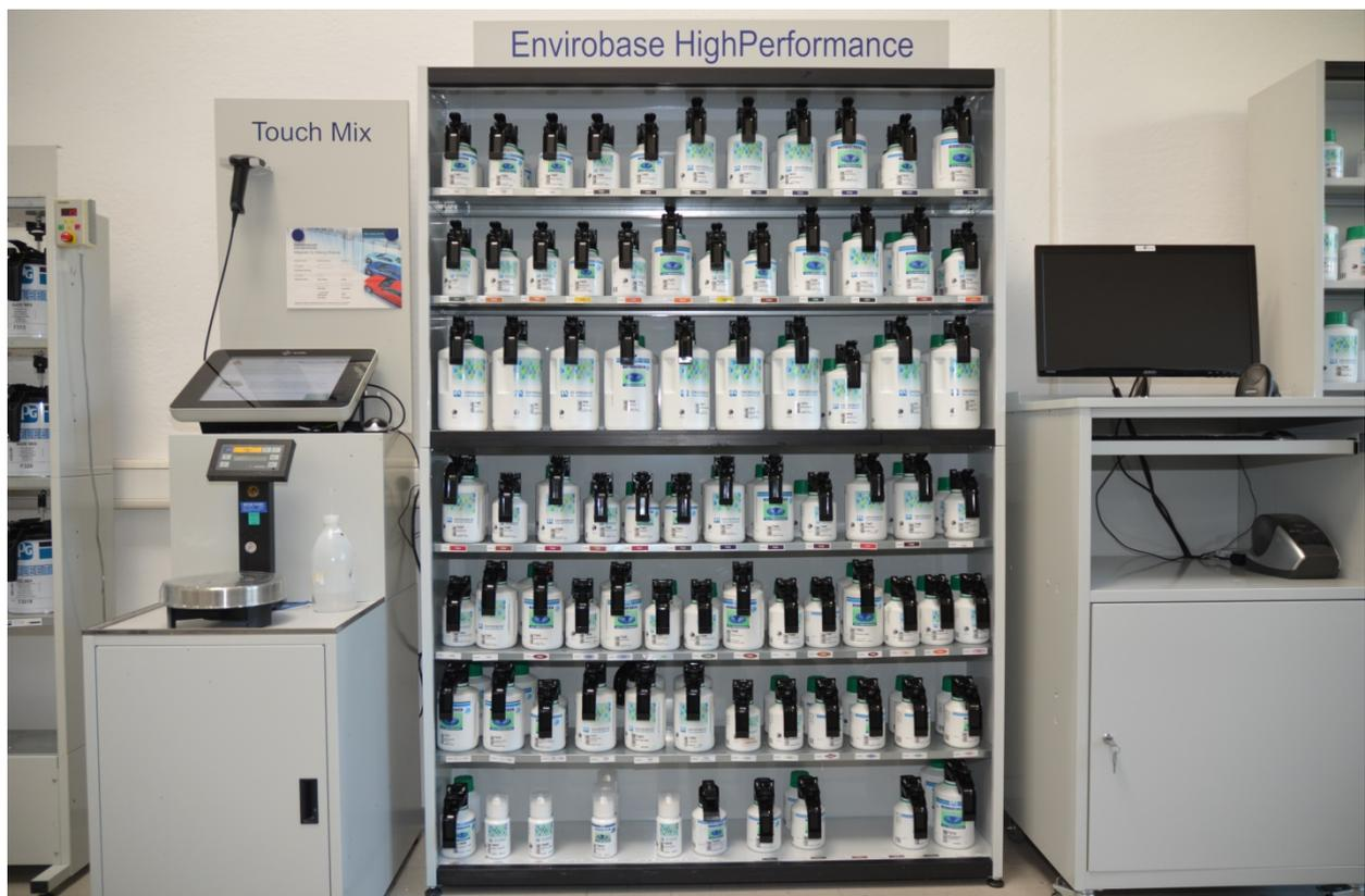
*Ein typisches Mischregal mit Waage und Datenbank der Mischrezepturen. Das Regal beinhaltet sowohl Unifarben (Buntpigmente) als auch Metallic- und Effekt-Mischlacke (Aluminium, Interferenzpigmente). Häufig verwendete Mischlacke werden in großen Gebinden angeboten.*
