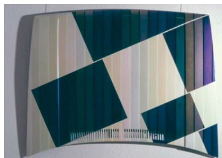
Abb. 1 // Eine lackierte Motorhaube zeigt über weißem Untergrund je nach Blickwinkel die Reflexions- oder die Transmissionsfarben. Über schwarzem Untergrund sind nur die Reflexionsfarben sichtbar.
