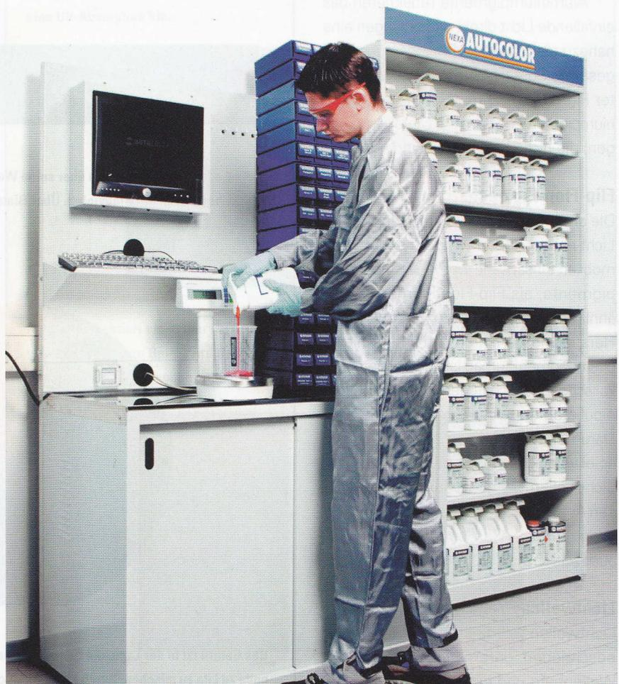
Mithilfe von Mischsystemen lassen sich fast alle Serienfarben in unterschiedlichen Lackqualitäten ausmischen. Zu einem Mischsystem gehört ein Regal mit Mischlacken, eine Waage und eine Formelsammlung.
