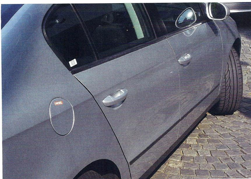
**Deutlich ist die nicht passende Farbe der hinteren Tür zu erkennen. Aufgrund falscher Aluminiumpigmente handelt es sich vermutlich um eine missglückte Reparaturlackierung**
