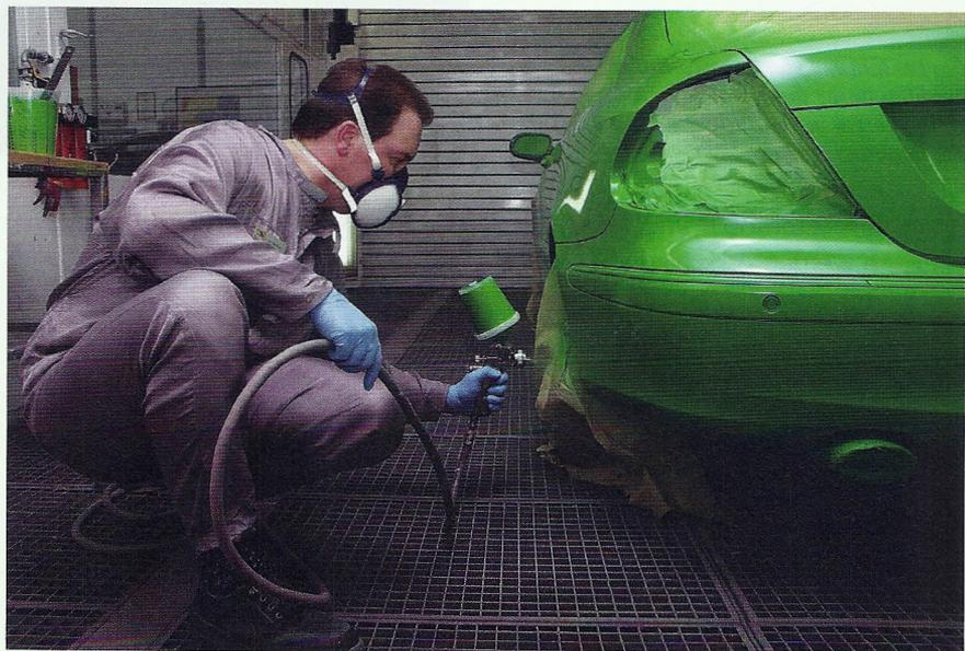
Bei der Lackierung von Kunststoffteilen sind unbedingt die Arbeitsvorschriften der Lackhersteller einzuhalten. Das gilt insbesondere für den Einsatz eines Weichmachers
