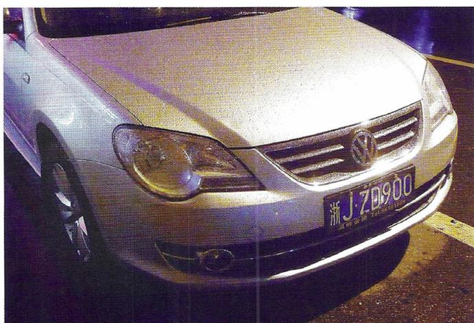
**Goldene Farben werden mit Interferenzpigmenten wirklich golden. Frühere Versuche mit Aluminium und gelben Mischlacken führten nicht zu diesem Eindruck**
