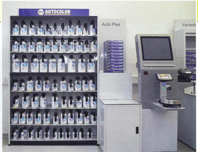
**Aufgrund des Lacksystems müssen die Mischlacke von Nexa Autocolor nicht gerührt werden. Die großen Gebinde sind griffbereit in der Mitte platziert**
