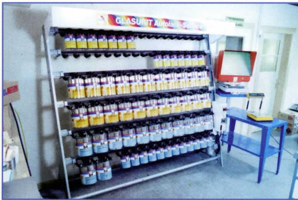
**Bild 10:** Um die immer größer werdende Zahl an Serienfarben auch für die Reparaturlackierung besser zu handhaben, führten die Lackhersteller in den 70er-Jahren Mischsysteme ein, mit denen die gewünschte Serienfarbe nach Rezeptur ausgemischt wird
