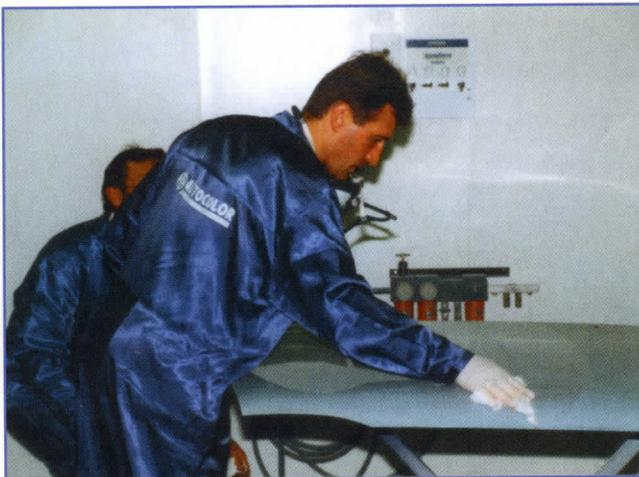
**Bild 8:** Eine Reinigung der Fläche muss zwischen jedem Arbeitsgang erfolgen
