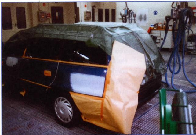
**Bild 5:** Werden Teile eines Fahrzeugs lackiert, müssen die restlichen Fahrzeugteile zugedeckt werden, damit kein Lackmaterial auf sie trifft
