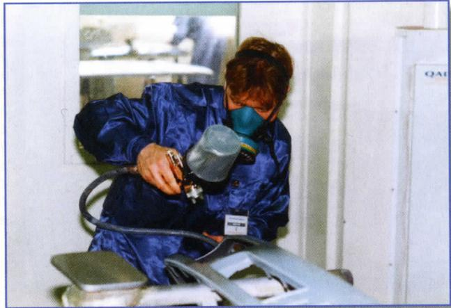
**Bild 6:** Bei ausgetauschten Teilen, wie z. B. Frontspoiler oder Tankklappe (siehe Bild 5), beginnt der Lackaufbau auf der angeschliffenen Grundierung
