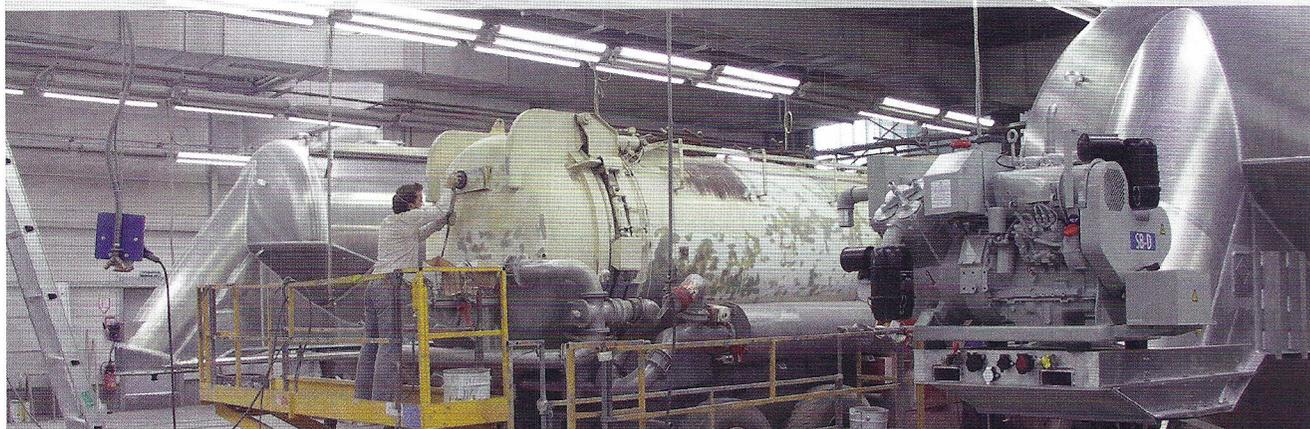
Neue und alte Siloaufbauten werden nach der Reinigung mit entsprechenden Reinigungsmaterialien angeschliffen
