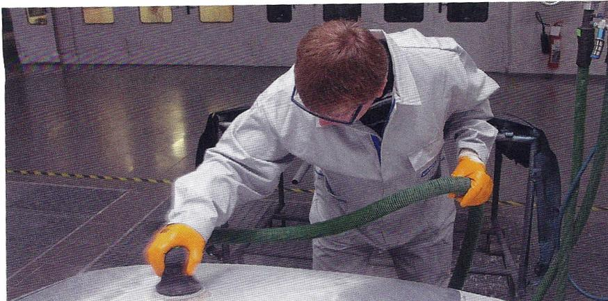
**Der maschinelle Trockenschliff der Altlackierung liefert eine gleichmäßige Schliiffläche**
