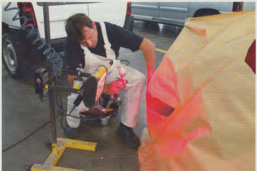
Kleine Reparaturstellen verlangen entsprechende Materialien und Techniken. Bei der sogenannten Spot Repair werden Reparaturen mit Mini-Spritzpistolen vorgenommen
