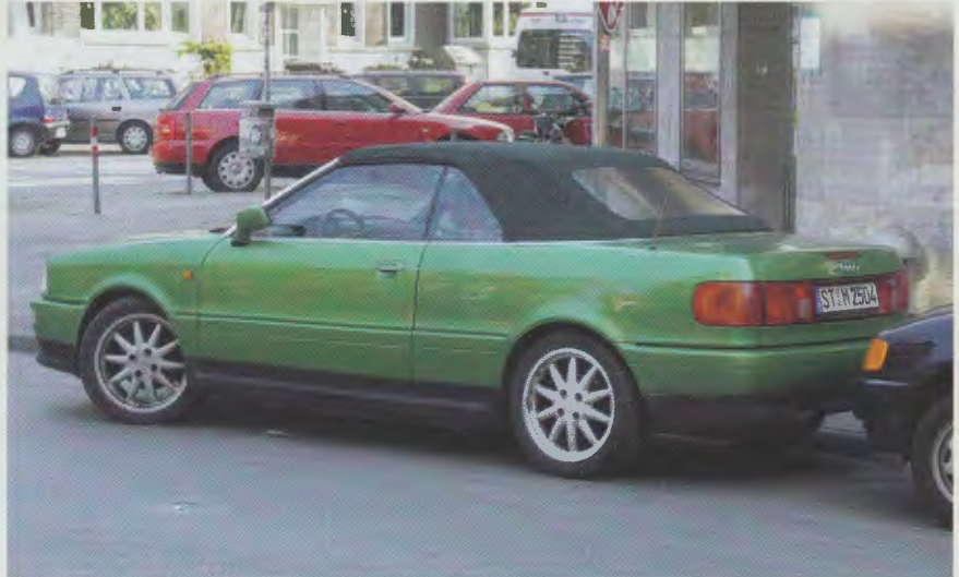
Mit der Beilackiertechnik wären diese Farbunterschiede schnell ausgeglichen. Wer hier an Zeit und Material spart, braucht sich über Reklamationen nicht zu wundern
