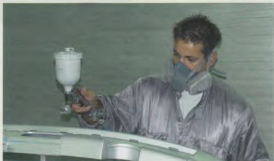
Bei der Lackierung von Kunststoffteilen sind unbedingt die Arbeitsvorschriften der Lackhersteller einzuhalten. Das gilt insbesondere für den Einsatz eines Weichmachers
