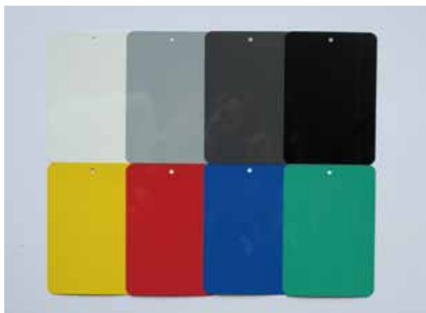
图5：样板：使用白光，由白至黑的四个增量的颜色进行颜色区分。如果用红光照射相同的样板，则黄色和红色变为白色和/或浅灰色。绿色和蓝色不反射任何红色光，所以显示为黑色。红色底涂层在彩色底涂层上显示出相似的光学反应。
