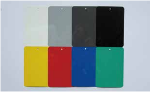
图5：样板：使用白光，由白至黑的四个增量的颜色进行颜色区分。如果用红光照射相同的样板，则黄色和红色变为白色和/或浅灰色。绿色和蓝色不反射任何红色光，所以显示为黑色。红色底涂层在彩色底涂层上显示出相似的光学反应。
